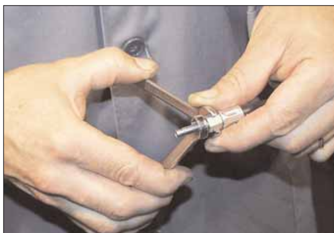
Fig. 24 Serraggio ugello su raccordo tubazione Solo per iniettori BRC
