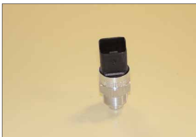
Fig. 03 Sensore di tempe- ratura acqua inseri- to sul riduttore Genius MB TH 2 O
