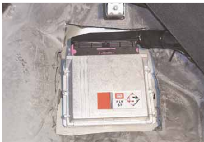
Fig. 27 Esempio di montag- gio centralina nell'a- bitacolo
