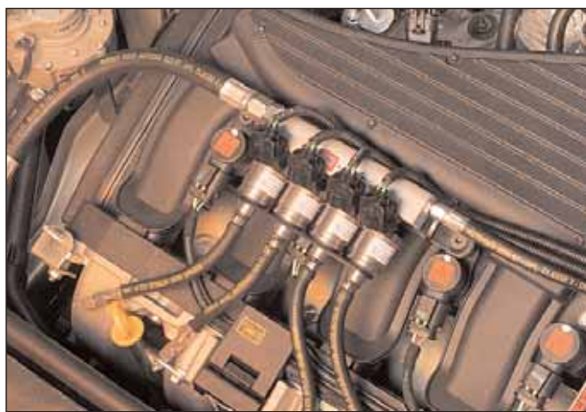
Fig. 13 Esempio installazione Rail con iniettori Keihin
