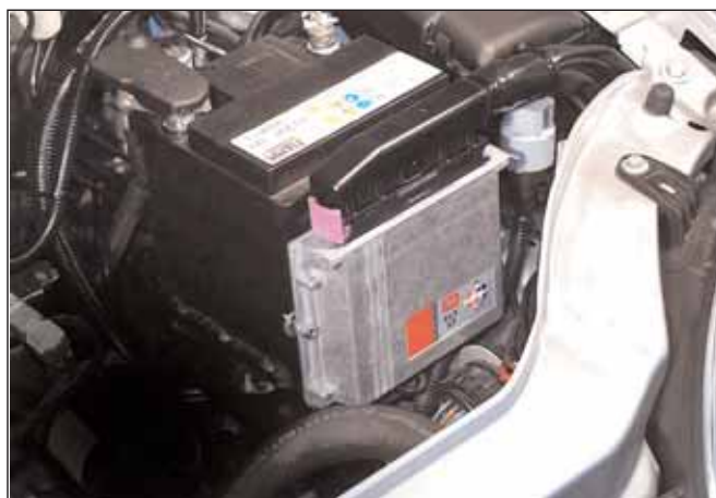
Fig. 28 Montaggio centrali- na nel vano motore
