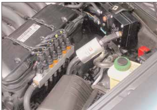
Fig. 14 Esemplare installazione Rail con iniettori BRC e sensore temperatura e pressione gas
