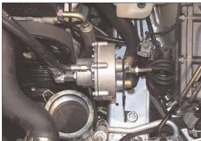
Fig. 01 Montaggio riduttore Genius Sequent con membrana parallela al senso di marcia
