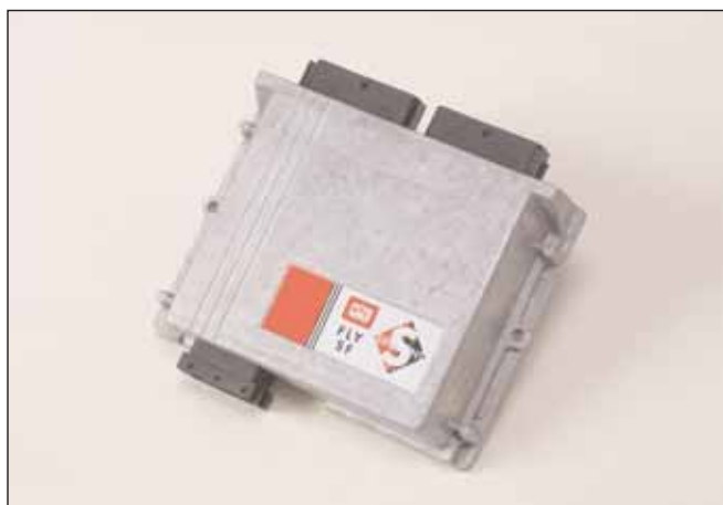
Fig. 28 Centralina Fly SF: versione a due connettori
