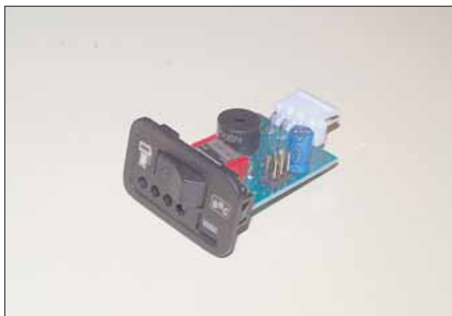
Fig. 32 Commutatore Full a due posizioni con avvisatore acustico senza scocca
