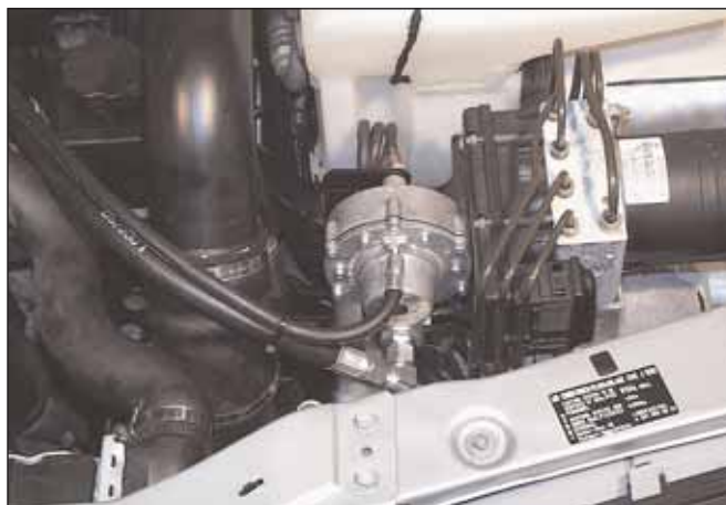
Fig. 02 Montaggio riduttore Genius Sequent con membrana perpendicolare al senso di marcia
